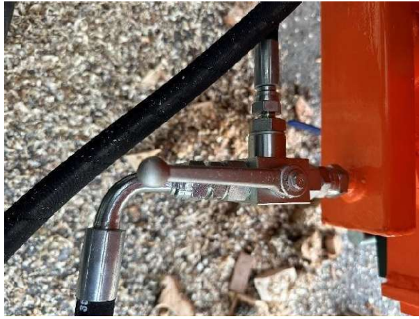
Fig. 9 Vanne du convoyeur
